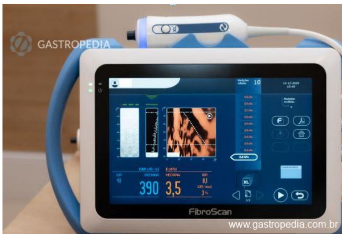
Figura 1. Modelo portátil de elastografia hepática transitória (FibroScan®, Echosens, Paris, França) e sonda XL.
